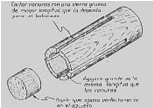
Consiste en un trozo cilíndrico de madera, en el cual se le ha practicado un gran agujero central y dos cortes gruesos de sierra. (Para hacer esto coloque en su segueta dos o tres hojas juntas) Tanto el agujero como los cortes deben ser más largos que la longitud de la bobina que se desea construir. Introduciendo por el extremo abierto un tapón capaz de conservar el diámetro original del cilindro, arrólese la bobina con el número de vueltas y el largo deseado y céméntese con cemento
